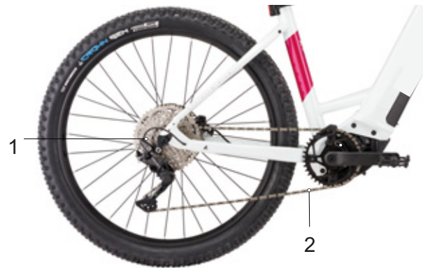
Afbeelding 26: Schema kettingaandrijving met derailleur
