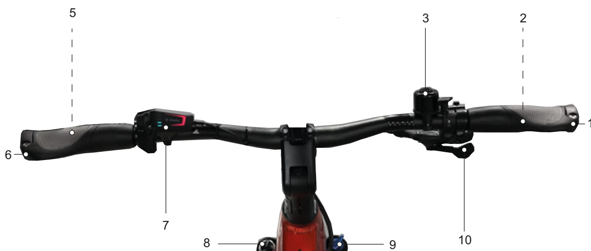
Afbeelding 33: Detailaanzicht stuur met BOSCH Kiox300, voorbeeld
