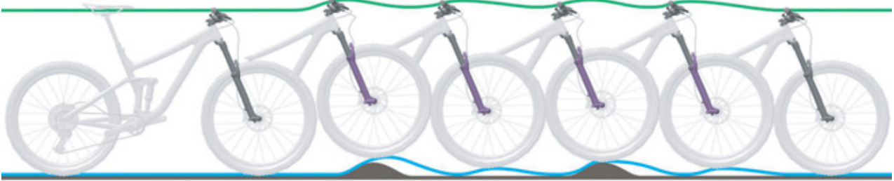
Afbeelding 194: Te snel uitveren van de verende voorvork
