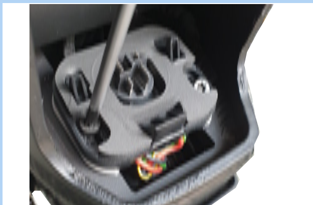
Afbeelding 38: Schroeven accuhouder losdraaien
