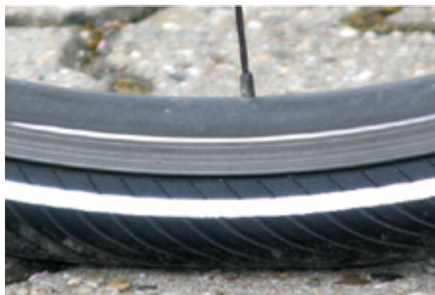
Afbeelding 78: Juiste vuldruk. De band is onder de belasting van het lichaamsgewicht nauwelijks vervormd
