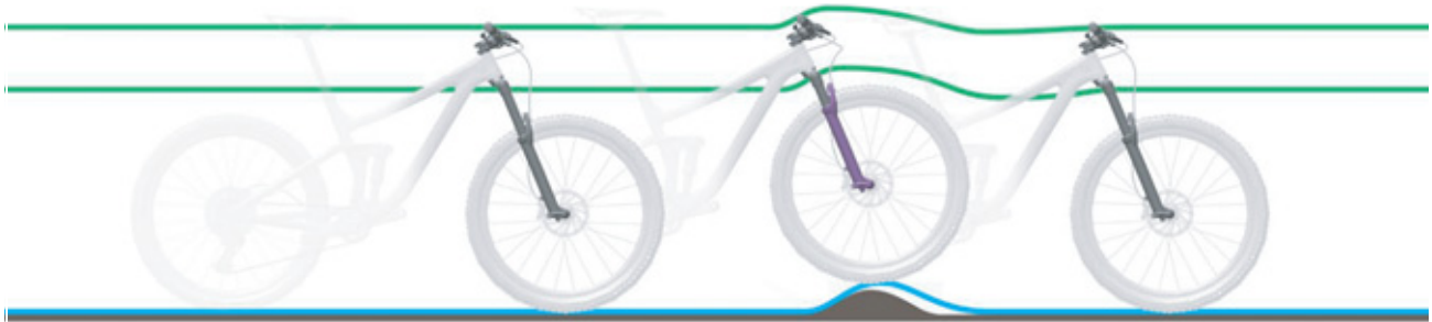
Afbeelding 200: Te harde demping de verende voorvork bij oneffenheden
