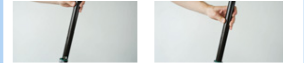
Afbeelding 167: Zadelpen omlaag schuiven
