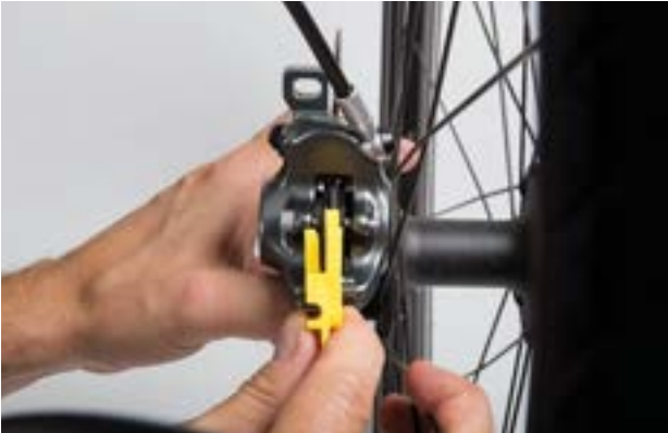
Afbeelding 121: Remvoering in gemonteerde toestand controleren met behulp van de transportbeveiliging
