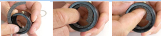
Afbeelding 180: Vilten ring inleggen
