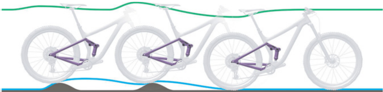
Afbeelding 99: Te langzaam uitveren van de achterbouwdeemper
