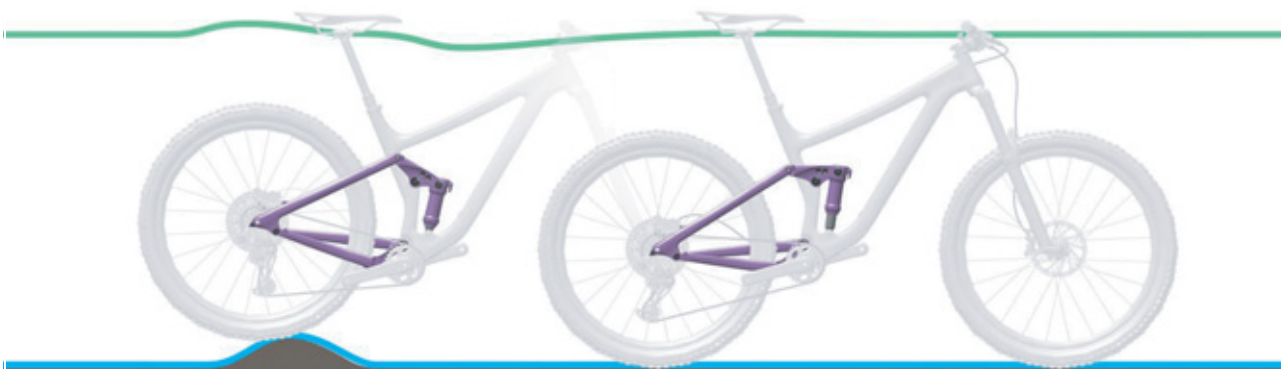
Afbeelding 69: Optimaal rijgedrag van de achterbouwdeemper bij oneffenheden
