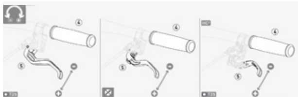
Afbeelding 51: Grijpafstand Magura schijfremhendel afstellen
