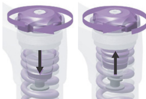
Afbeelding 55: Voorspanningsafstelling in- en uitdraaien
