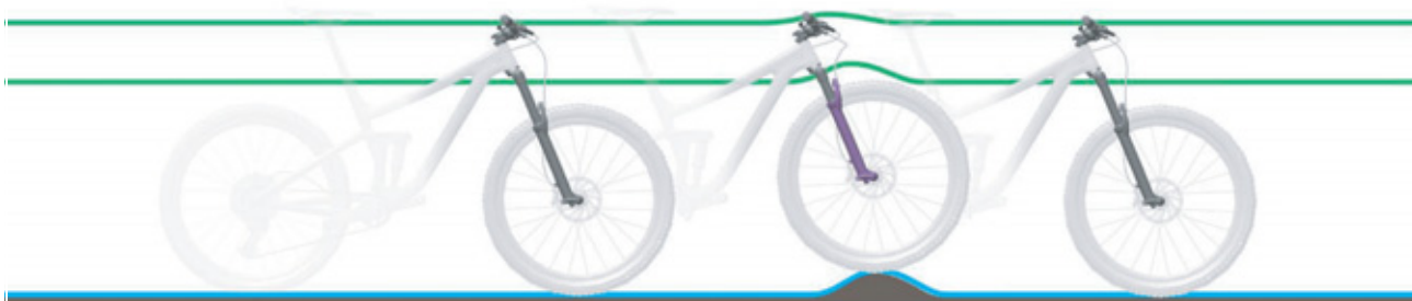
Afbeelding 76: Optimaal rijgedrag bij oneffenheden
