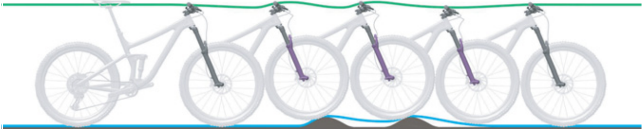
Afbeelding 91: Te langzaam uitveren van de verende voorvork
