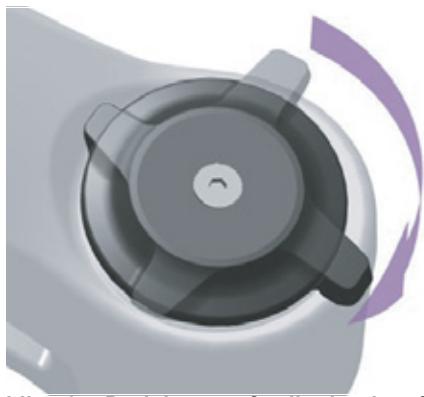
Afbeelding 94: Drukdemperafsteller harder afstellen
