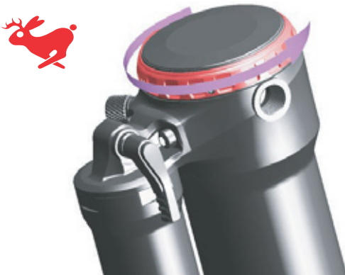
Afbeelding 100: Draai de trekdemperafsteller in de richting van de haas
