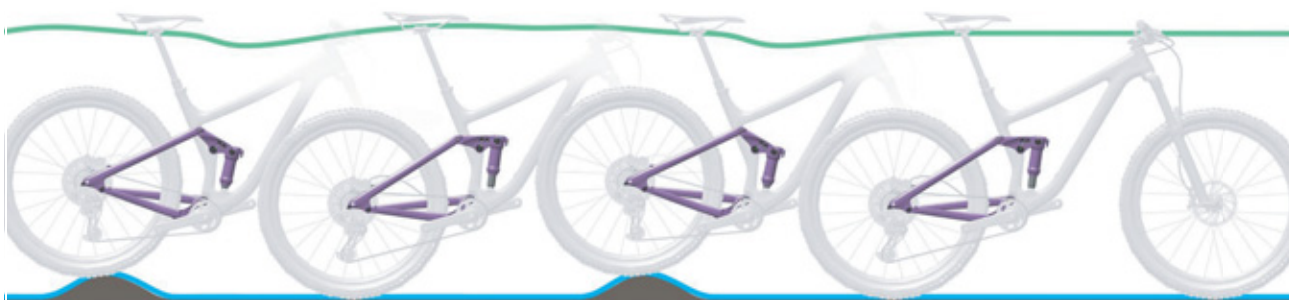
Afbeelding 62: Optimaal rijgedrag van de achterbouwdemper
