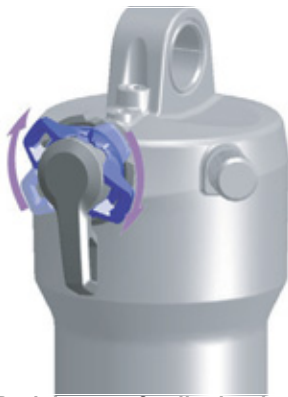
Afbeelding 102: Drukdemperafsteller harder afstellen
