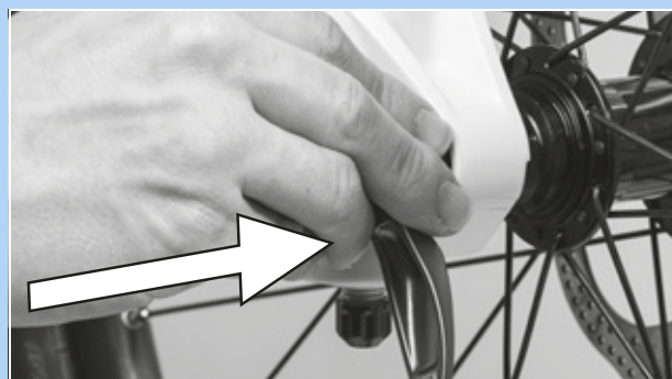
Afbeelding 82: Snelspanner in de richting van de pijl inschuiven
