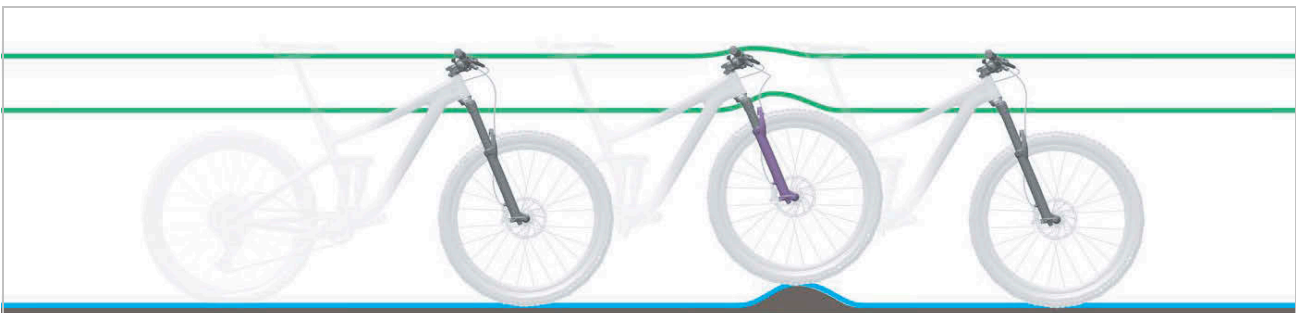
Afbeelding 14: Optimaal rijgedrag van de vork bij oneffenheden
