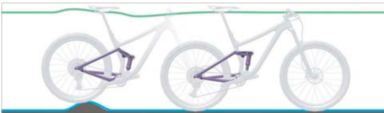
Afbeelding 168: Optimaal rijgedrag van de achterbouwdemper bij oneffenheden
