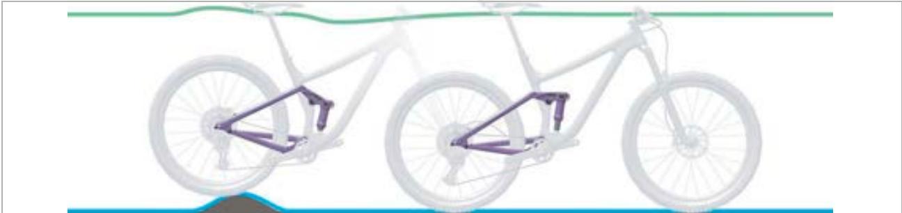
Afbeelding 7: Optimaal rijgedrag van de achterbouwdeemper bij oneffenheden
