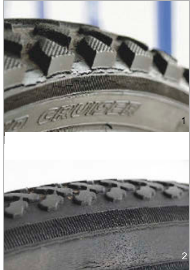
Afbeelding 195: Voorbeelden van vermoeiingsscheuren (1) en verouderingsscheuren (2)
