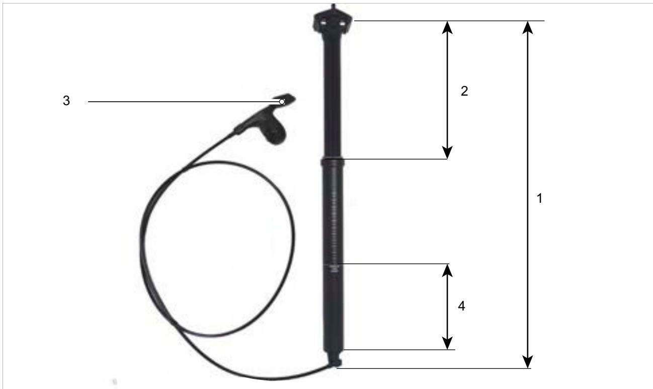
Afbeelding 46: Opbouw en afmetingen van de zadelpen LIMOTEC A1
