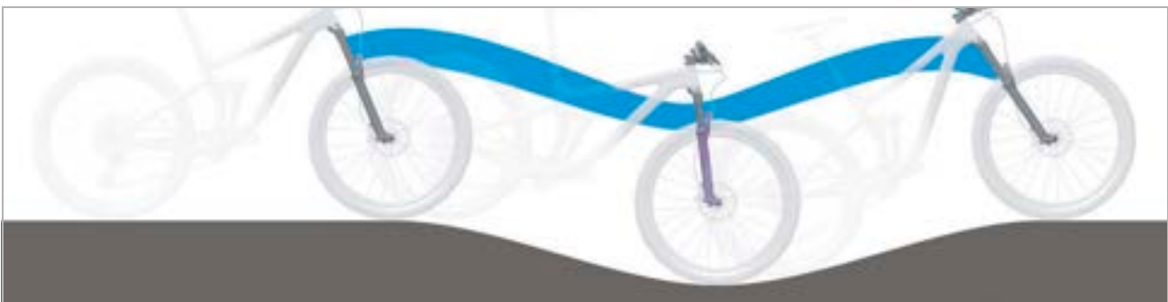
Afbeelding 19: Optimaal rijgedrag van de vork in heuvelachtig terrein
