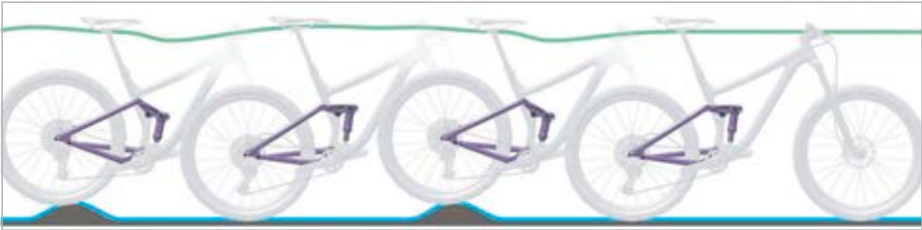
Afbeelding 8: Optimaal rijgedrag van de achterbouwdemper
