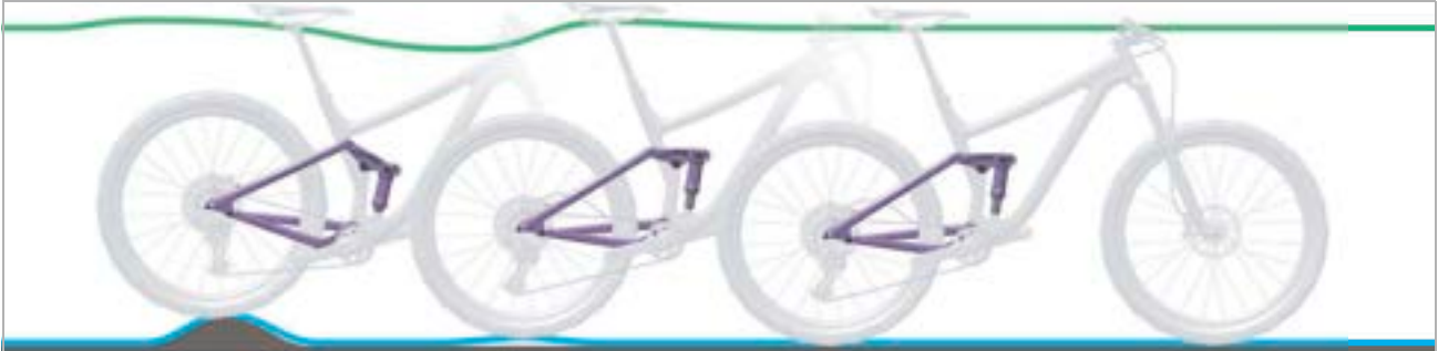
Afbeelding 234: Te snel uitveren van de achterbouwdeemper
