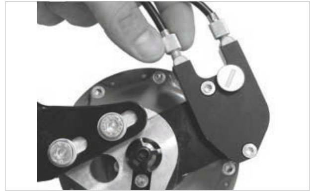
Afbeelding 221: Bij ROHLOFF naafversies met externe schakelaansturing zit de kabelafsteller op de kabelbox aan de linkerkzijde
