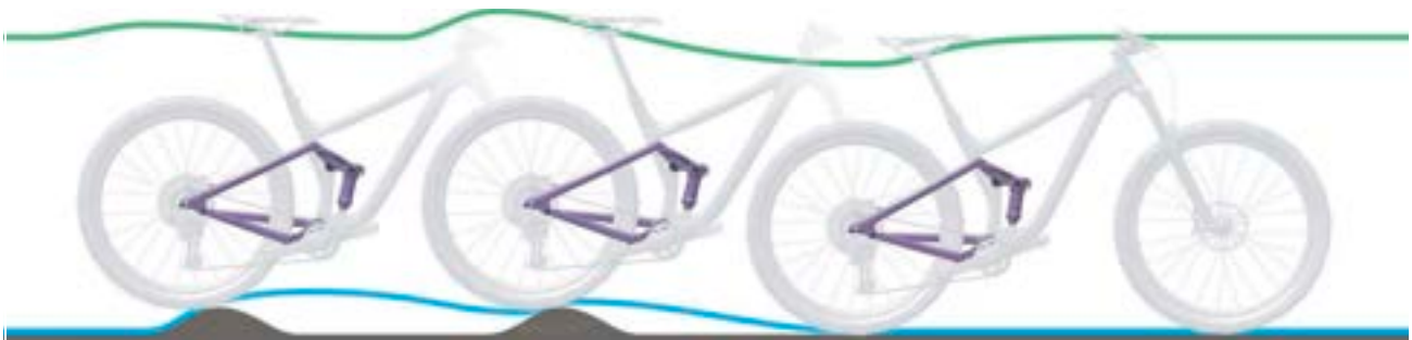
Afbeelding 236: Te langzaam uitveren van de achterbouwdemper
