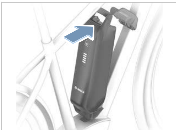
Afbeelding 173: PowerPack accu omhoog klappen
