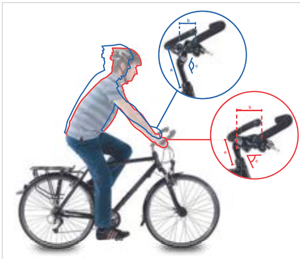
Afbeelding 125: Stadsfiets- (blauw) en toerfietsstand (rood) door verandering van de hoek
