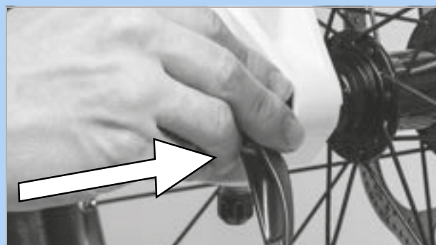
Afbeelding 95: Snelspanner in de richting van de pijl inschuiven
