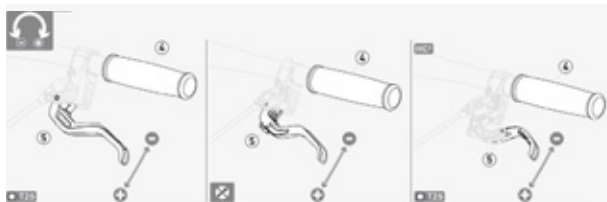
Afbeelding 42: Grijpafstand Magura schijfremhendel afstellen
