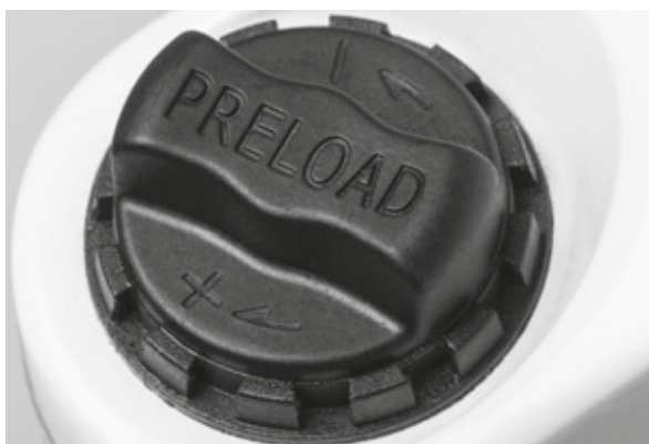
Afbeelding 44: Afstelwiel voor de negatieve veerweg op de kroon van de verende voorvork
