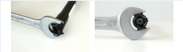
Afbeelding 183: Borgen tegen verdraaien
