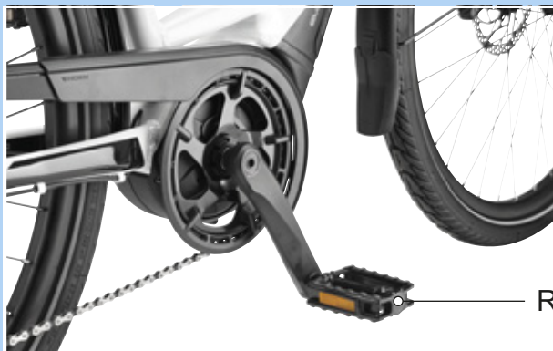
Afbeelding 87: R-pedaal in de rechter crankarm
