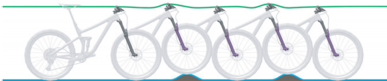
Afbeelding 119: Optimaal rijgedrag van de vork
