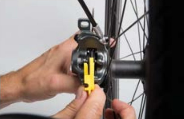
Afbeelding 151: Remvoering in gemonteerde toestand controleren met behulp van de transportbeveiliging
