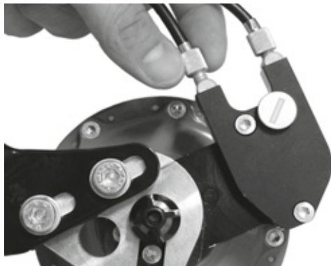
Afbeelding 155: Bij Rohloff naafversies met externe schakelaansturing zit de kabelafsteller op de kabelbox aan de linkerkant.
