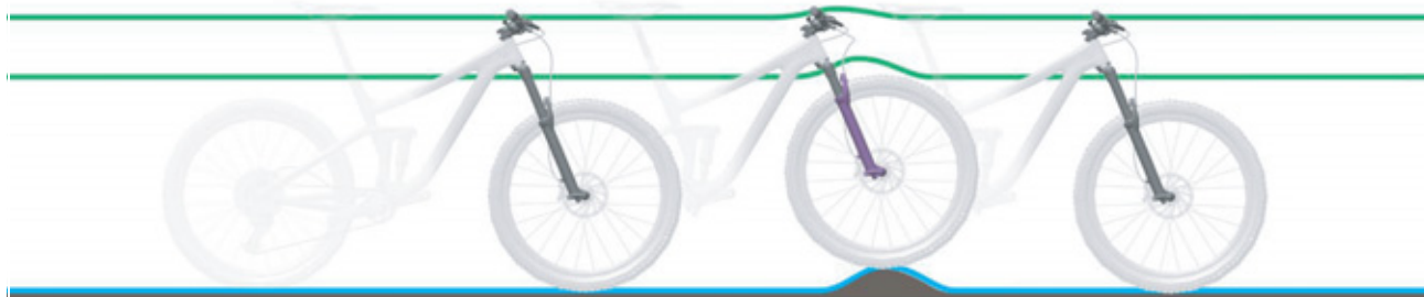
Afbeelding 138: Optimaal rijgedrag bij oneffenheden
