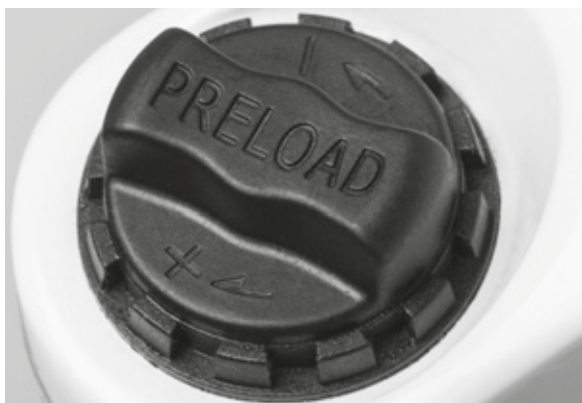
Afbeelding 61: Afstelwiel voor de negatieve veerweg op de kroon van de verende voorvork
