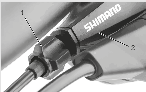
Afbeelding 89: Afstelwartel (1) van de versnelling met enkele bowdenkabelbediening en behuizing van de schakelhendel (2), voorbeeld
