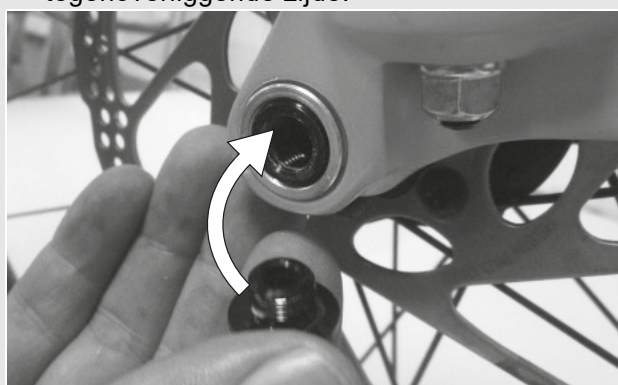
Afbeelding 30: Snelspanhendel in as schuiven
