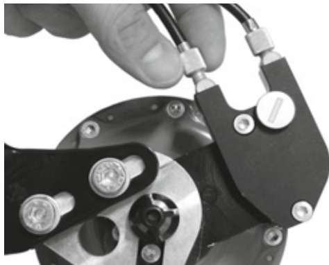
Afbeelding 125: Bij Rohloff naafversies met externe schakelaansturing zit de kabelafsteller op de kabelbox aan de linkerkant.
