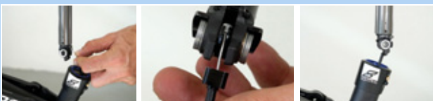
Afbeelding 190: Zadelpen ophangen en inschuiven
