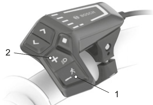
Afbeelding 108: Locatie plus-toets en min-toets
