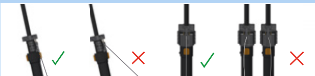
Afbeelding 159: Correcte en verkeerde bowdenkabel
