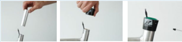
Afbeelding 179: Glijbus en buitenhuls monteren
