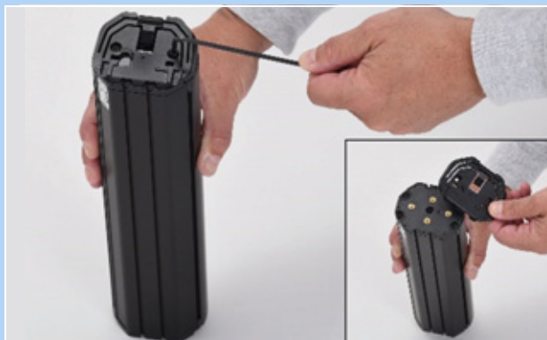
Afbeelding 61: Demontage bovenste interface
