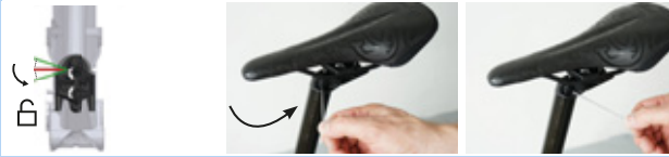
Afbeelding 155: Bediening hoogteverstelling in stand "geopend" zetten
