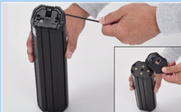
Afbeelding 58: Demontage bovenste interface
