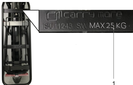
Afbeelding 122: Op de bagagedrager staat het maximale draagvermogen (1) vermeld
