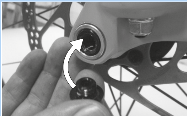
Afbeelding 67: Snelspanhendel in as schuiven
