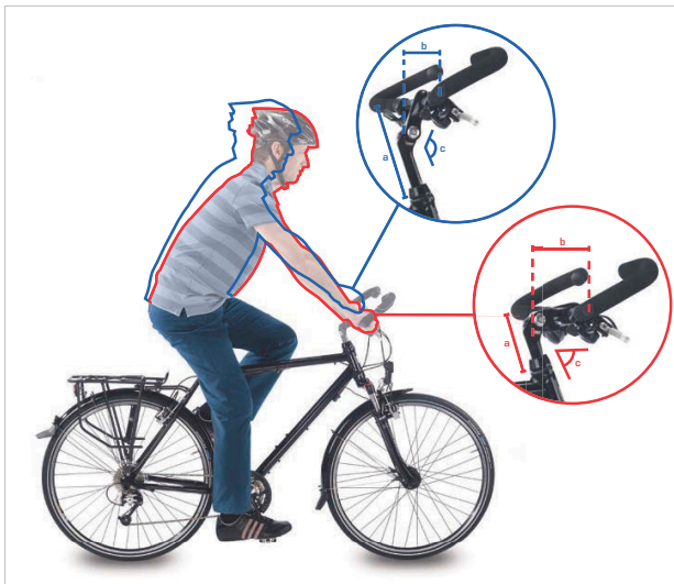
Afbeelding 94: Stadfiets- (blauw) en toerfietsstand (rood) door verandering van de hoek
