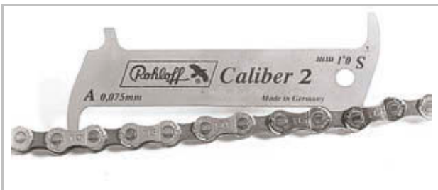
Afbeelding 145: Voorbeeld kaliber ROHLOFF
