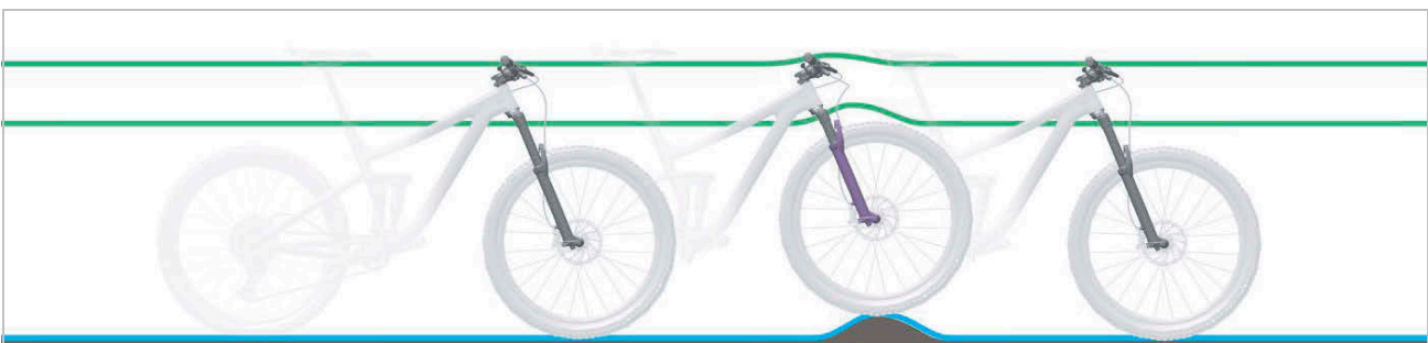
Afbeelding 14: Optimaal rijgedrag van de vork bij oneffenheden
