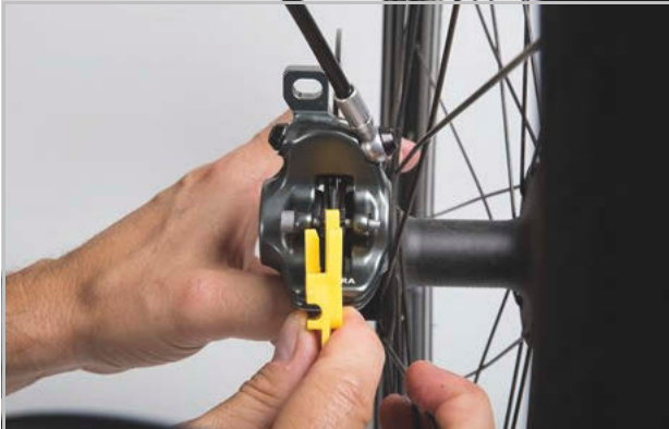
Afbeelding 140: Remvoering in gemonteerde toestand controleren met behulp van de transportbeveiliging
