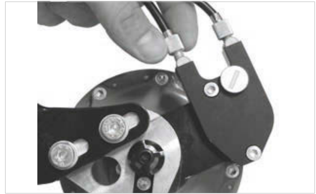
Afbeelding 165: Bij ROHLOFF naafversies met externe schakelaansturing zit de kabelafsteller op de kabelbox aan de linkerkzijde
