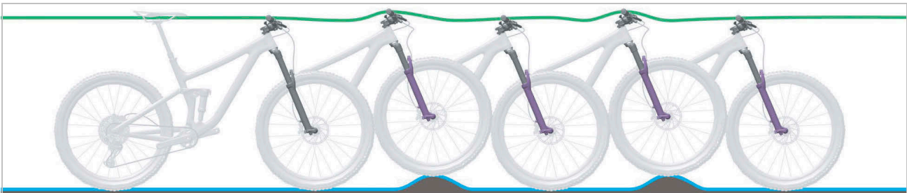
Afbeelding 15: Optimaal rijgedrag van de verende voorvork
