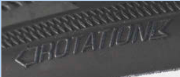
Afbeelding 113: Pijl draairichting
