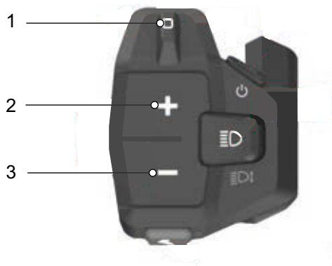
Afbeelding 188: Locatie navigatiewip (1), plus- (2) en min- (3) toets
