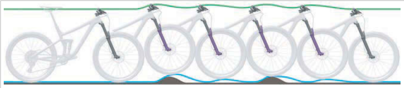
Afbeelding 275: Te snel uitveren van de verende voorvork
