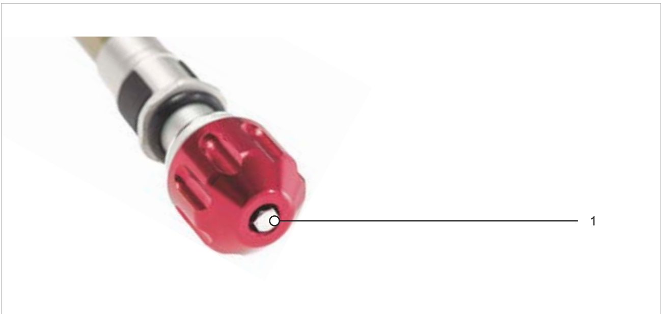
Afbeelding 222: Voorbeeld SR SUNTOUR trekdemperschroef (1)
