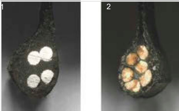
Afbeelding 28: draadkern (1) en Kevlarkern (2)
