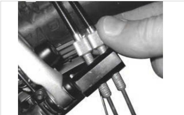
Afbeelding 211: Bij ROHLOFF naafversies met interne schakelaansturing zit de kabelafsteller op de tegenhouder van de kabel
