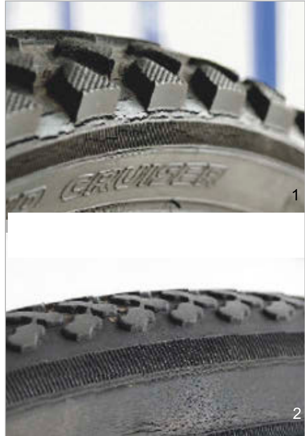
Afbeelding 186: Voorbeelden van vermoeiingsscheuren (1) en verouderingsscheuren (2)
