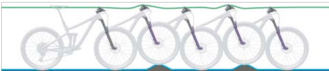
Afbeelding 136: Optimaal rijgedrag van de vork
