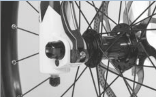
Afbeelding 91: Perfecte stand van de spanhendel
