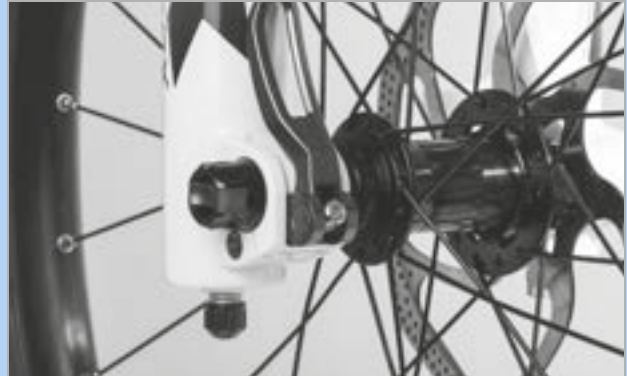
Afbeelding 215: Spankracht van de snelspanner afstellen
