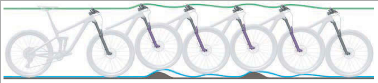
Afbeelding 219: Te snel uitveren van de verende voorvork
