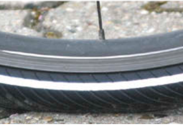
Afbeelding 126: Juiste vuldruk. De band is onder de belasting van het lichaamsgewicht nauwelijks vervormd
