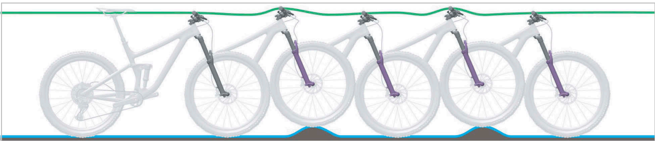
Afbeelding 21: Optimaal rijgedrag van de vork
