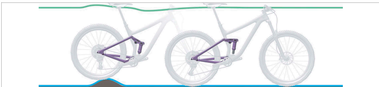
Afbeelding 141: Optimaal rijgedrag van de achterbouwdeemper bij oneffenheden
