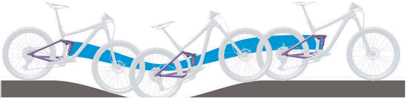
Afbeelding 238: Te zachte vering van de achterbouwdemper bij kuilen
