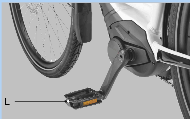
Afbeelding 101: L-pedaal in de linker crankarm
