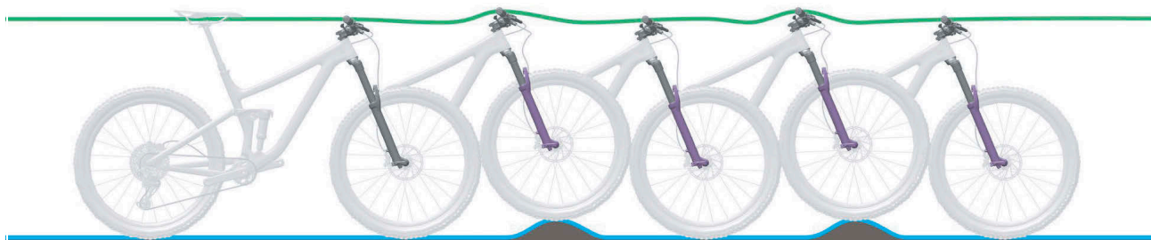
Afbeelding 143: Optimaal rijgedrag van de vork
